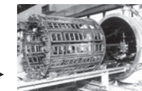
液晶ディスプレイ開発に貢献した透明導電膜成膜装置
