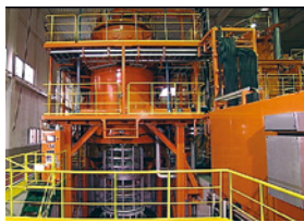
縦型一室式真空炉 (国内最大)
