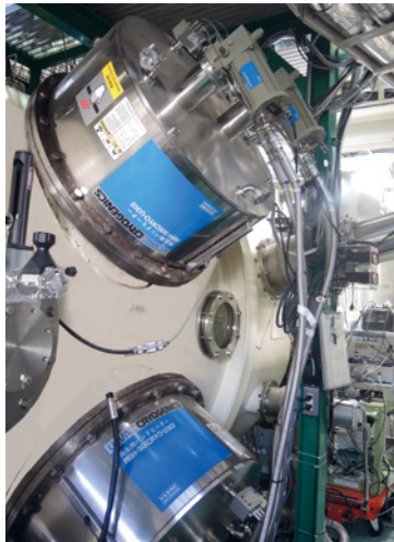
イオンエンジンの耐久試験で活躍したスペースチャンバーに組み込まれたクライオポンプ (アルバック・クライオ製)
