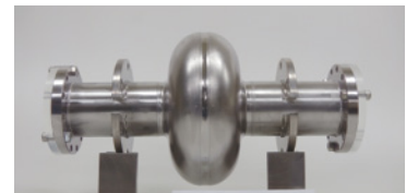
高エネルギー加速器研究機構で製作したアルバック製ニオブ材の1セル加速空洞
