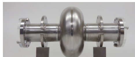
超伝導加速器用高純度ニオブ材料
