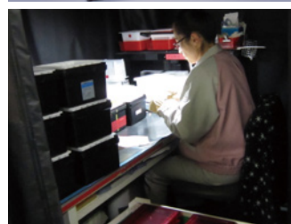
半導体用マスクブランクス（上） ガラス基板にキズがないか、暗室で一枚ずつ目視で確認する（下）
