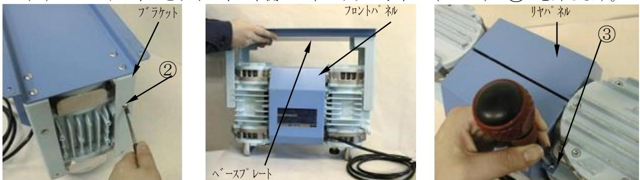
(5) 本体の向きを元に戻し、フロントパネル上側の2本のトラス小ネジ（M4×6L）④を外し、フロントパネルを外します。
