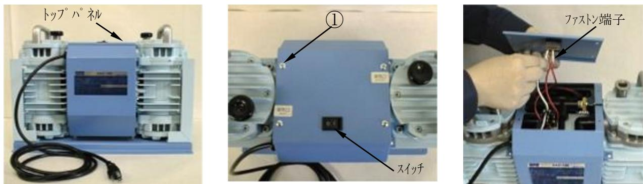
(3) 本体を逆にし、ブラケットの8本のトラス小ネジ（M5×10L）②を外してポンプ本体をベースプレートから外します。
