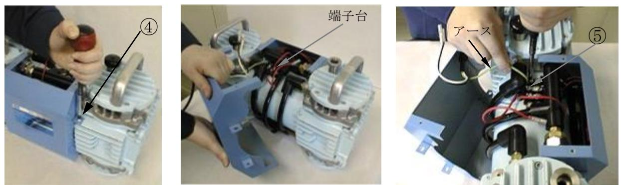
(7) リヤパネル上側の2本のトラス小ネジ（M4×6L）⑥を外し、写真の様に持ち上げて、冷却ファンに接続されているビニール皮膜コード（赤）のファストン端子を外します。リヤパネルを外します。
