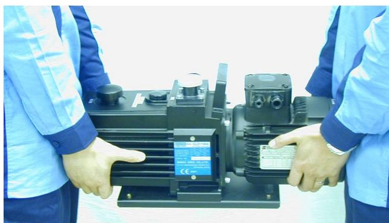
図3. 油回転真空ポンプの移動方法
