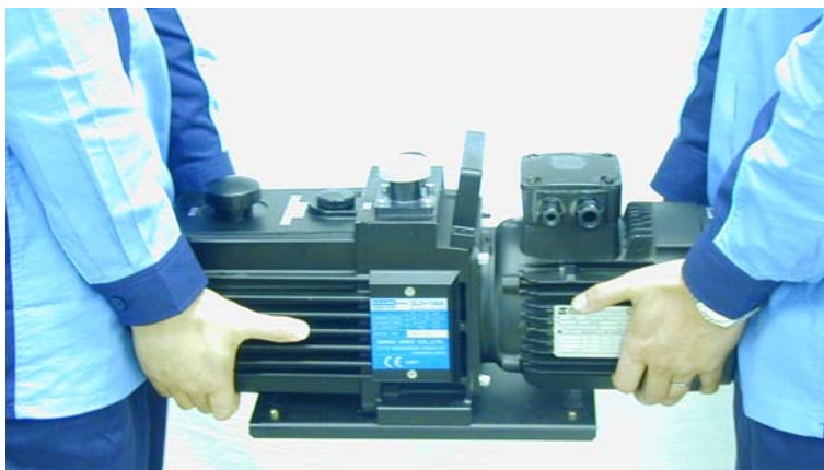
図3. 油回転真空ポンプの移動方法
