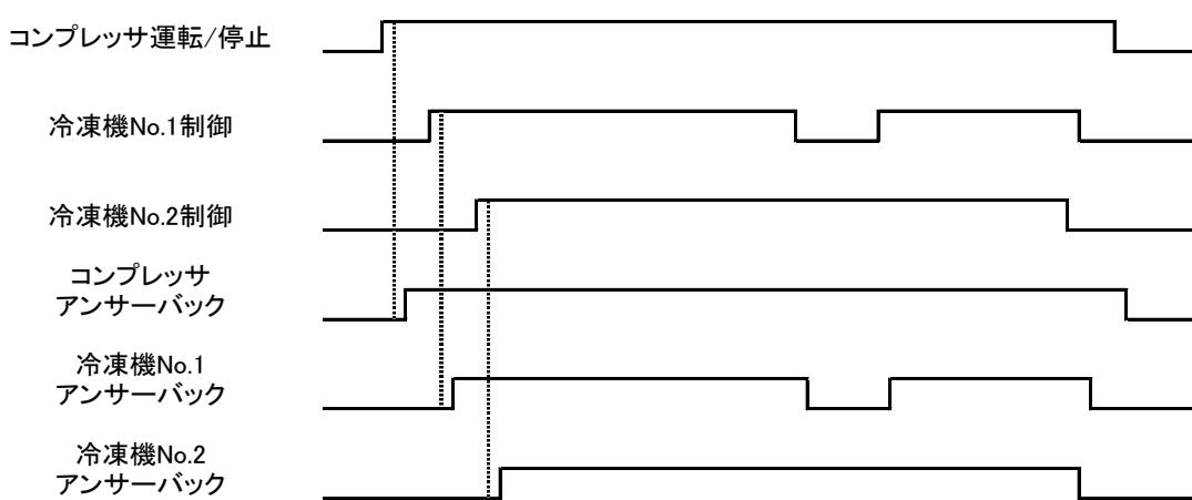
図 2-7 2 台の冷凍機の運転を「オールタネート操作モード」で行う場合のタイムチャート
