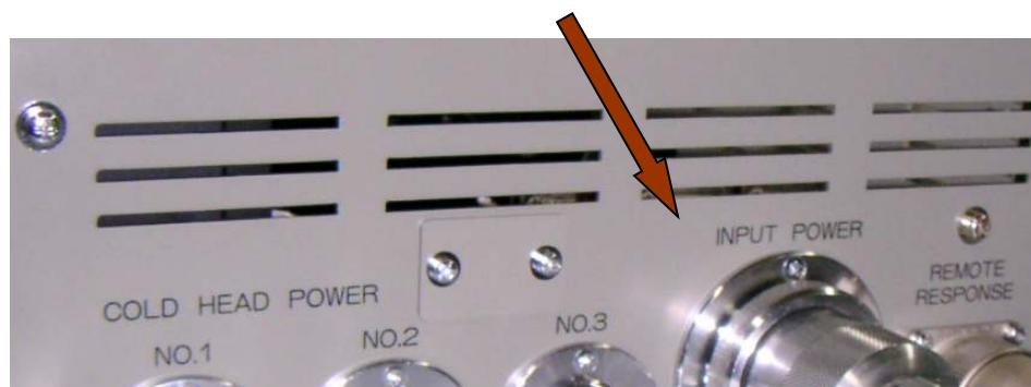
図 4-7 電源ケーブルコネクタの接続
