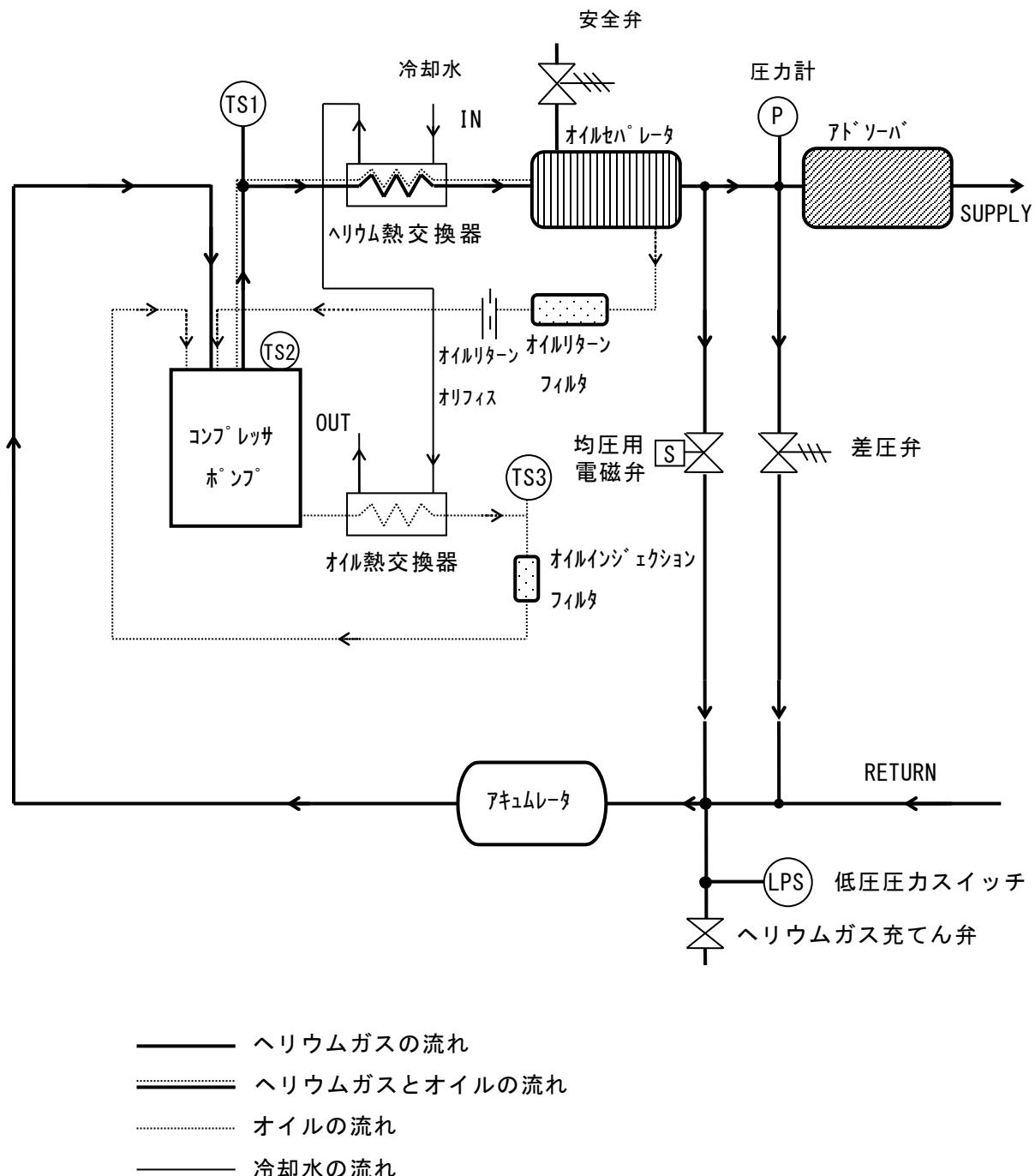
図D-1 コンプレッサフロー図
