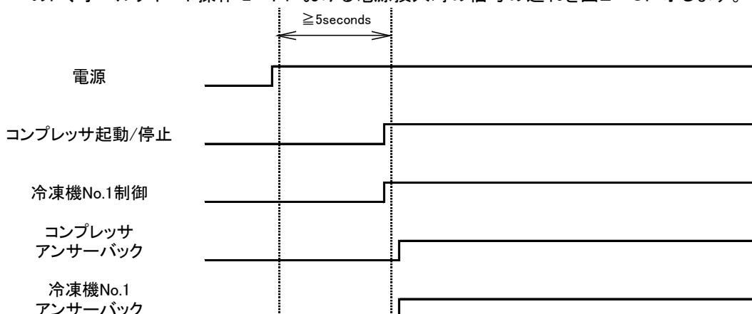
図 2-9 電源投入時の信号の遅れ（オールタネート操作モードの場合）
