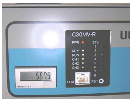
図 5-4 C30MVR 運転中のステータス表示
