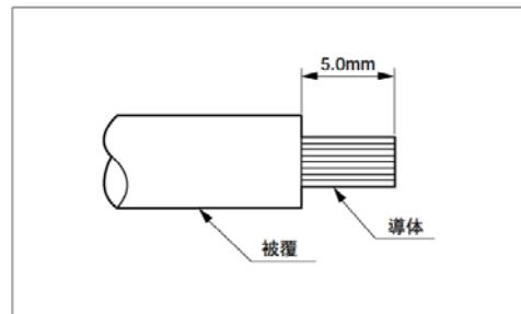
図 4-13 電線被覆剥き寸法
