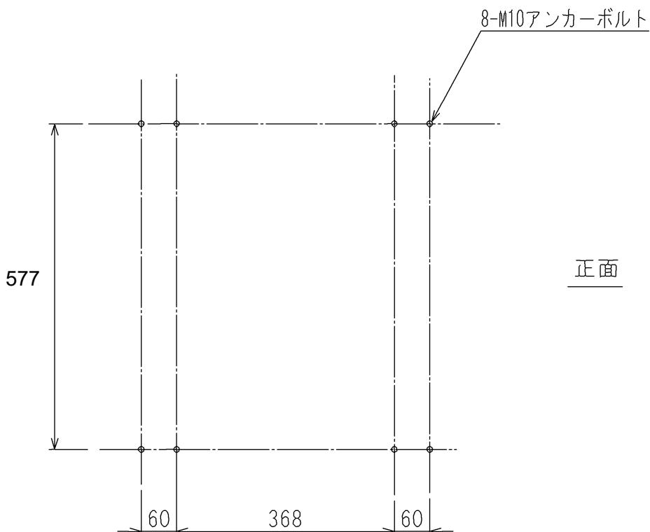
**図 1-8 アンカーボルト固定位置 (例)**
