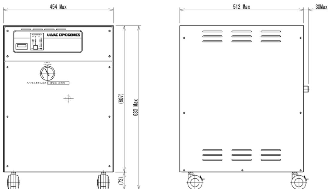
図 1-2 C30HMVRT コンプレッサの外形寸法
