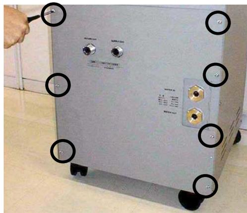
図 7-2 リアパネルのネジ7個を外す
