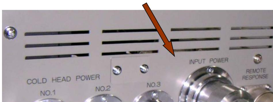
図 4-6 電源ケーブルコネクタの接続
