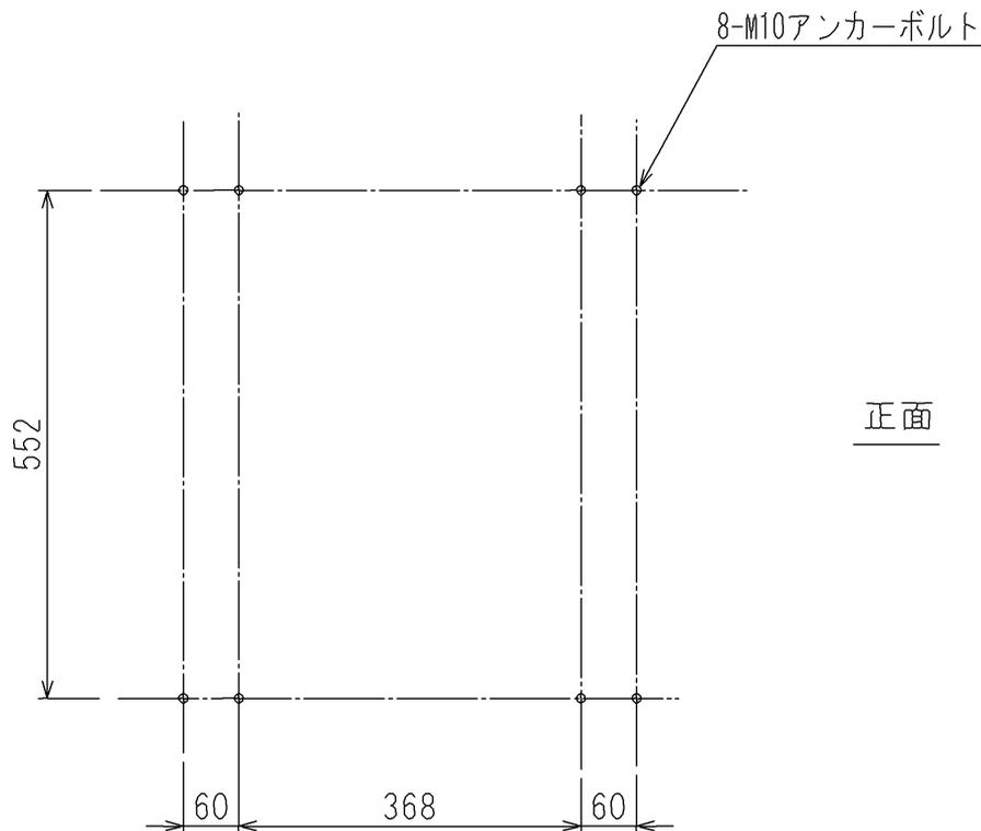
図 1-5 アンカーボルト固定位置(例)
