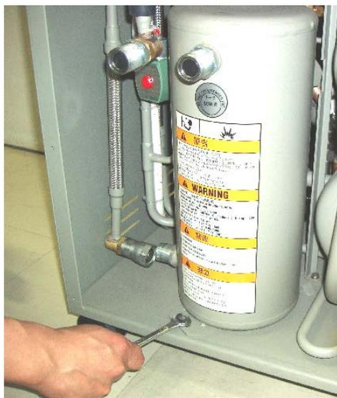
図 7-6 アドソーバ取付けボルトを外す
