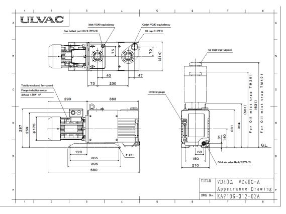
Fig. 5 Dimensional drawing VD40C, VD40C-F, VD40C-N
