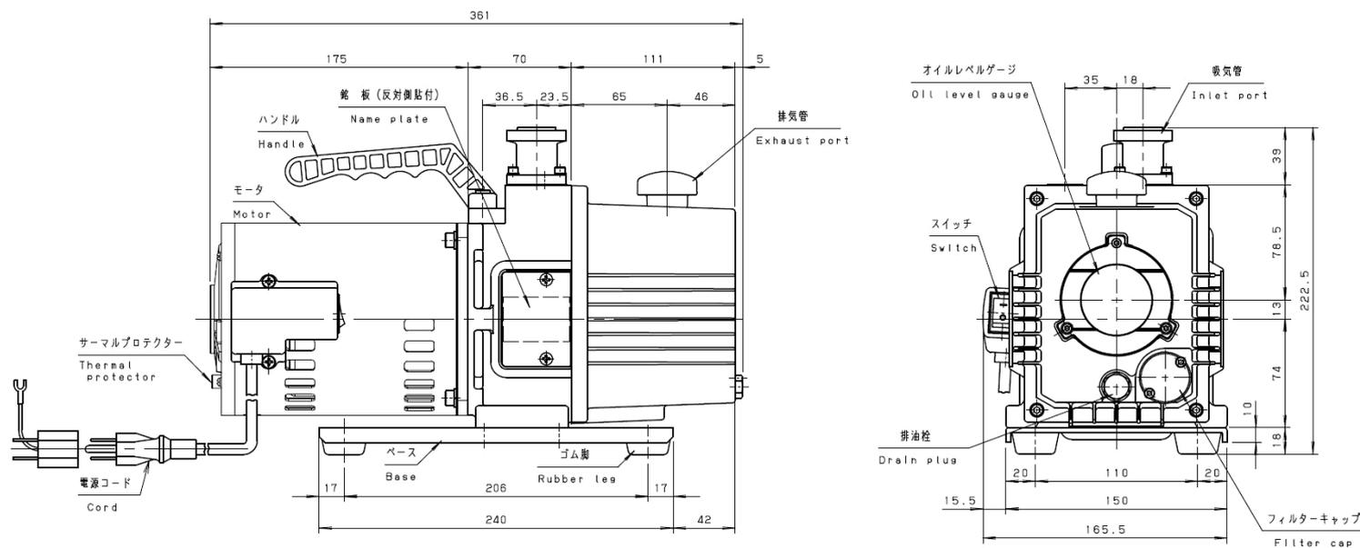
図2. GLS-051 油回転真空ポンプ寸法図
