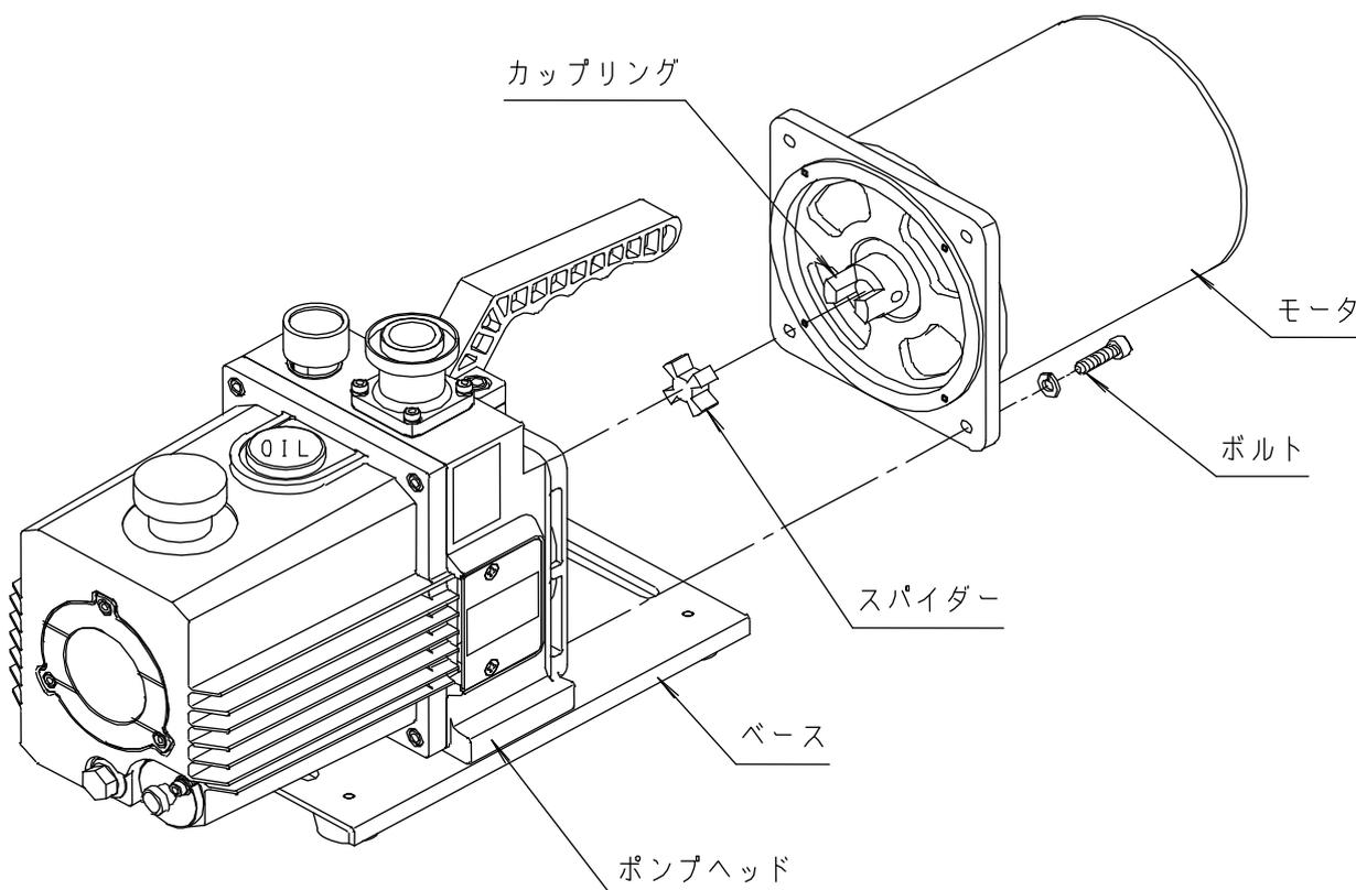
図8. カップリングのスパイダー交換
