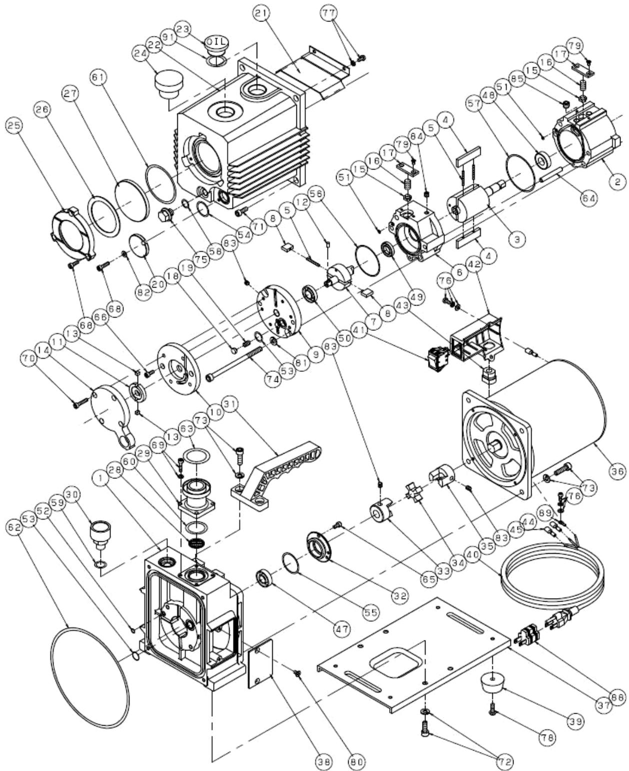
図9. GLD-051 油回転真空ポンプ分解図
