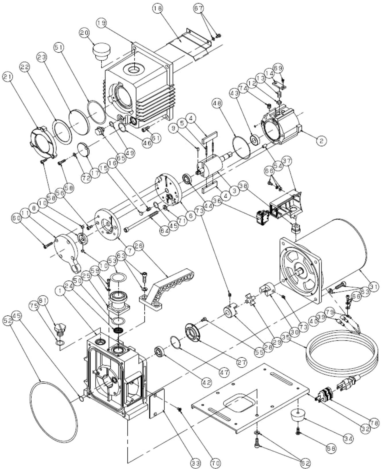
図10. GLS-051 油回転真空ポンプ分解図
