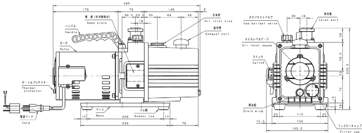
図1. GLD-051 油回転真空ポンプ寸法図
