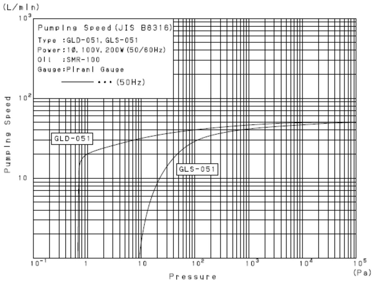
図6. 排气速度曲线
