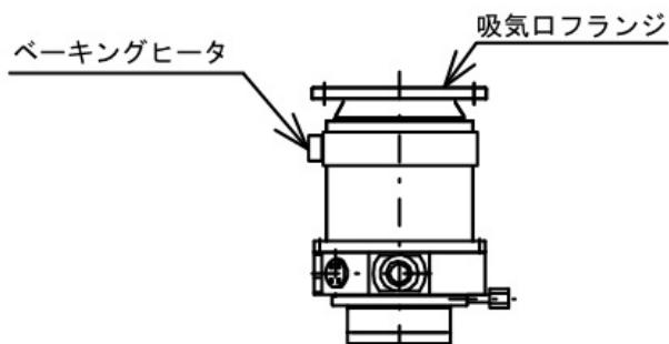
図 6-1 ベーキングヒータの取り付け例
