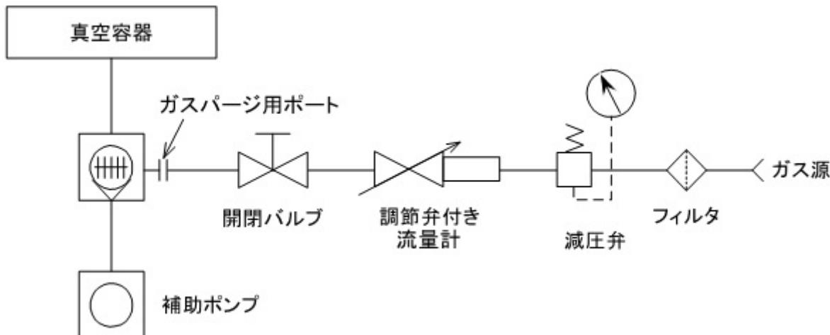
図 7-1 ガスページの方法 (オリフィス径 Φ0.5 mm)
