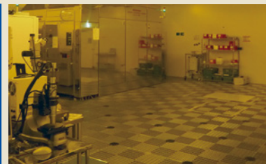
「連邦規格クラス1」スーパークリーンルーム。2014年1月、手前のスペースに新型超高速電子線描画装置F7000S-VD02が導入された。
