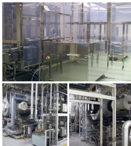
アルバック製凍結真空乾燥装置 上：自動入庫無菌室側、下：機械室側
