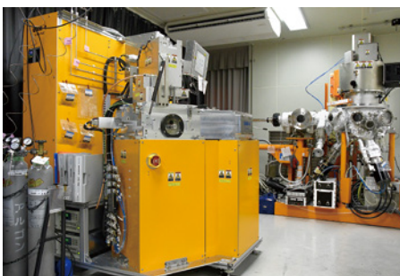
スパッタリング小型薄膜形成 研究開発実験装置「QAM (キャム)」
