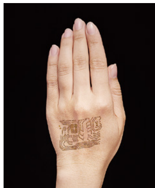
図4 皮膚貼り付け型ナノメッシュ電極を手の甲に装着した。皮膚の形状にもピッタリと沿って貼り付いている。極薄で超軽量であり、自然な皮膚呼吸が実現されているため、装着感がない。
