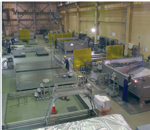
真空チャンバーがいくつも並ぶ溶接現場
